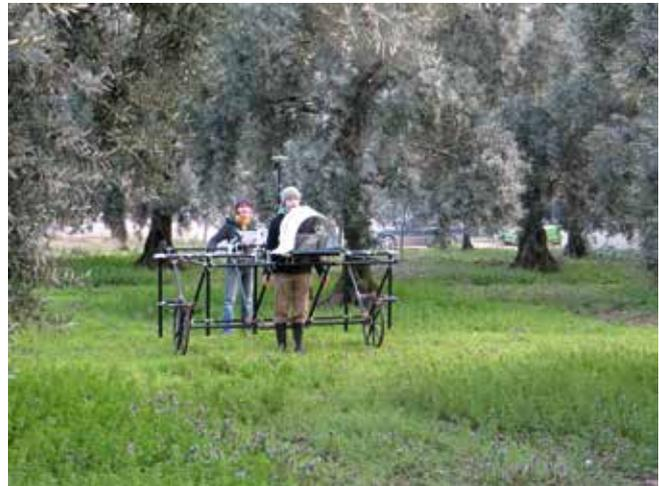
Abb. 103: Iznik: Geomagnetische Prospektion der CAU Kiel, Foto: E. Erkul.
