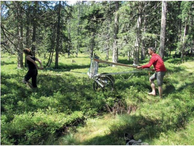
Abb. 85-1: Prospektionsarbeiten durch die Fa. Eastern Atlas (Dr. Burkhard Ullrich) am Schmelzplatz 52 am Wildersee; dabei konnten Verfahren der geoelektrischen Tonographie mit hochauflösender Magnetik kombiniert werden; Foto: RUB/DBM, E. Hanning, B. Ullrich.
