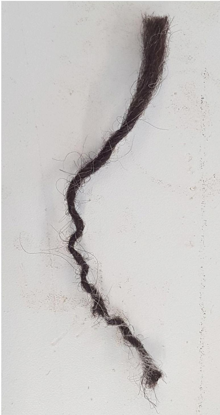
Abb. 6 Teilweise gesponnener Faden, der sich an einem Ende löst
